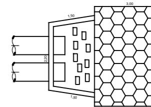
DETALHE DISSIPADOR DE ENERGIA
